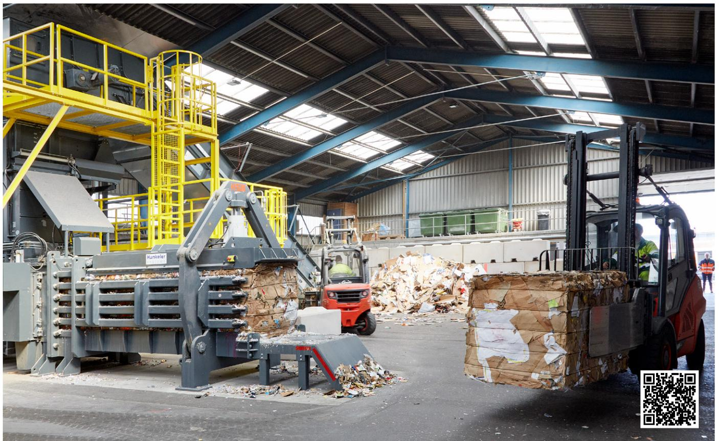
La presse comprime le papier et le carton en balles d'un poids pouvant atteindre une tonne. Jusqu'à 5,5 tonnes de matériel sont traitées en l'espace de vingt minutes.
