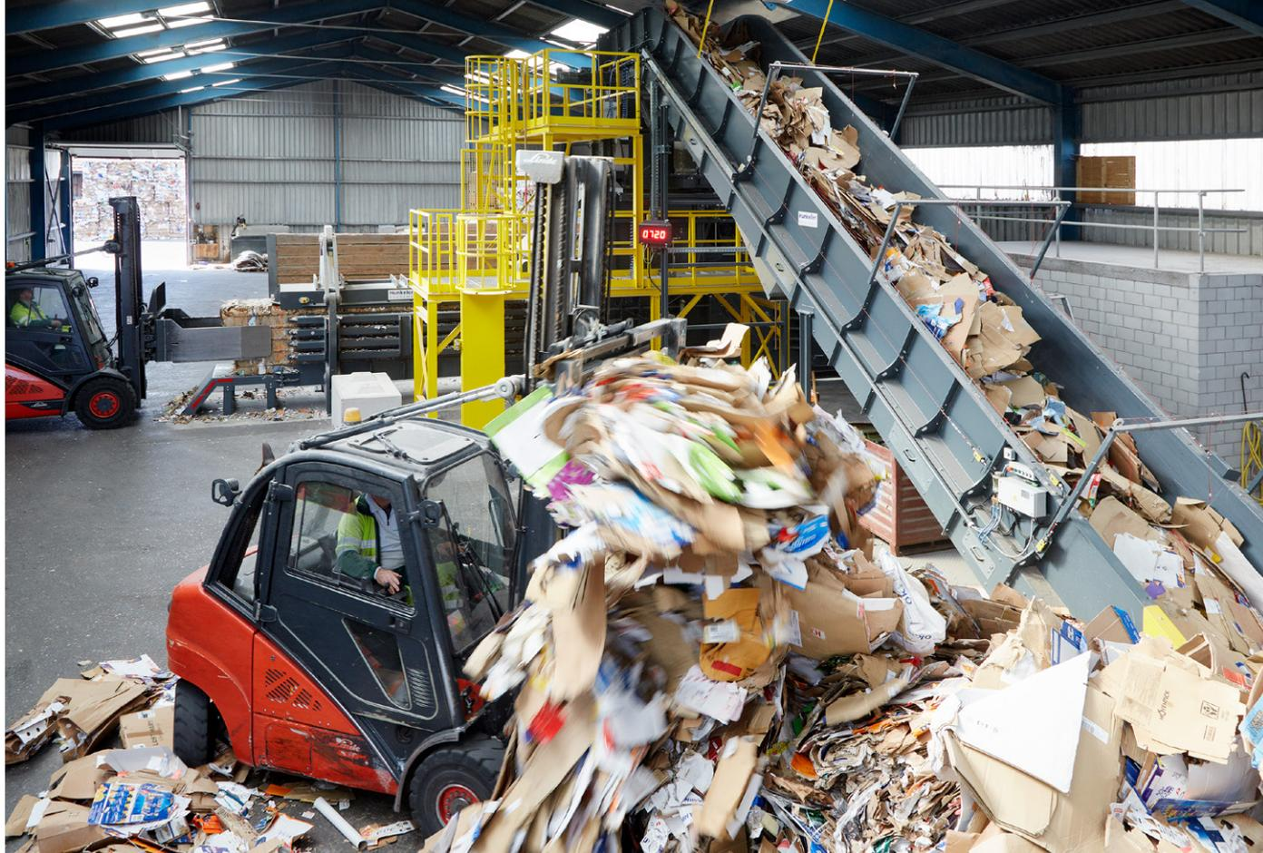
La presse à balles est conçue pour un volume annuel de 15 000 tonnes. Elle fonctionne de manière économique ; un convertisseur de fréquence commande son fonctionnement. La presse ne consomme de l'énergie électrique que lorsqu'il y a des matériaux à compacter.
