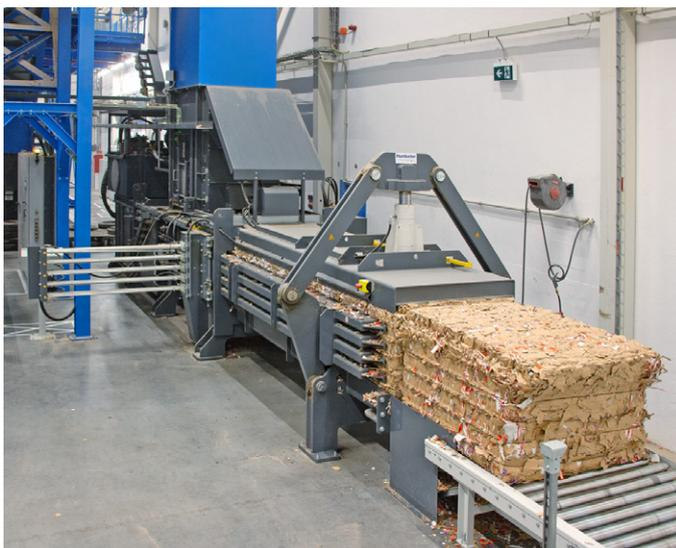
Die Presse stösst jede Stunde zwölf bis dreizehn Ballen mit einem Gewicht von jeweils 450 bis 500 Kilogramm aus. Ein Portalkran entnimmt die Ballen und stellt sie in einem Zwischenlager für den Abtransport bereit.
