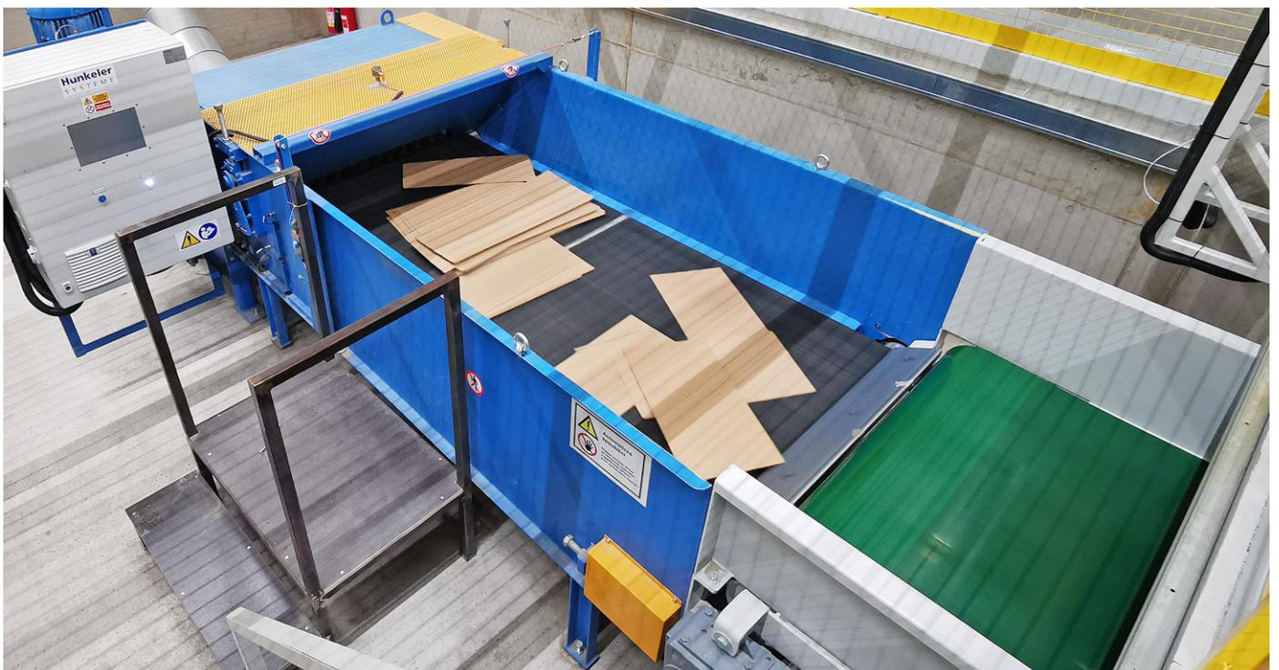
Während eines Format- und Auftragswechsels müssen innerhalb einer sehr kurzen Zeitspanne sehr hohe Wellpappenmengen in einem Schredder zerkleinert und pneumatisch an die Ballenpresse überführt werden.
