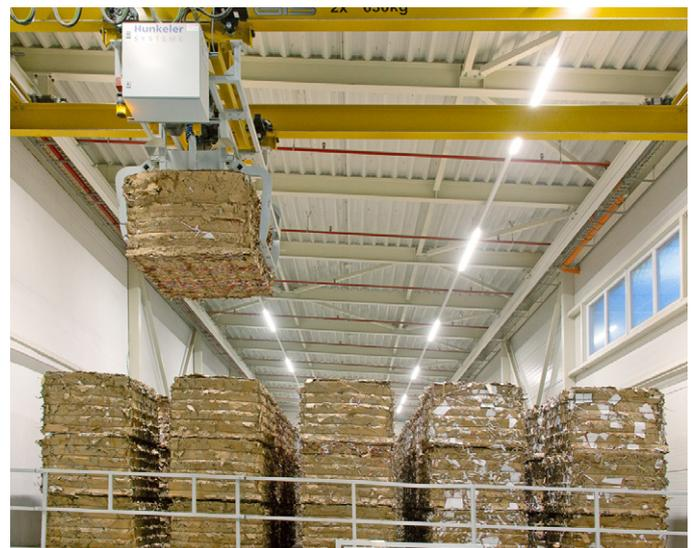
End-to-End-Automatisierung: Von der Entsorgung der Papier- und Kartonabfälle über deren Verdichtung in einer Hochleistungsballenpresse bis zum Absetzen der Ballen über einen Portalkran läuft der Workflow bei Model Obaly in Nymburk komplett automatisch ab.
