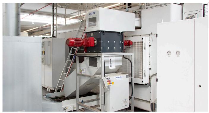
Dank der Zerkleinerung der Greiferränder direkt an einer Bobst Mastercut 2.1 konnte Smurfit Kappa die Produktivität im Stanzprozess spürbar steigern.
