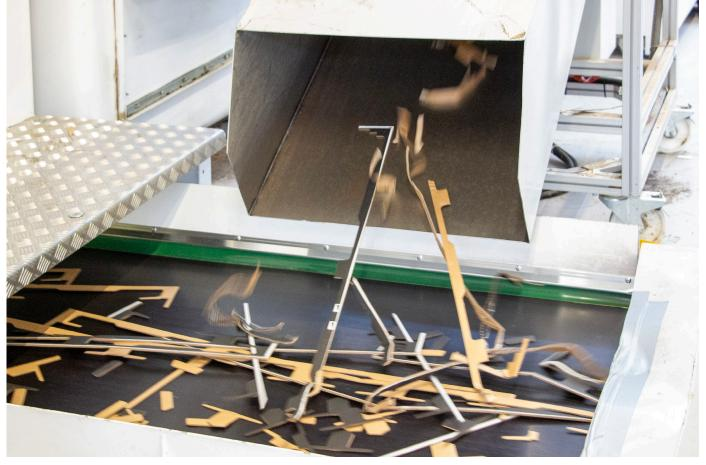
Auch grössere, bis zu 150 Millimeter breite Greiferränder zerkleinert der Schredder HKZ-700 problemlos. Ein Transportband entfernt die Abfälle aus dem Produktionsbereich.
